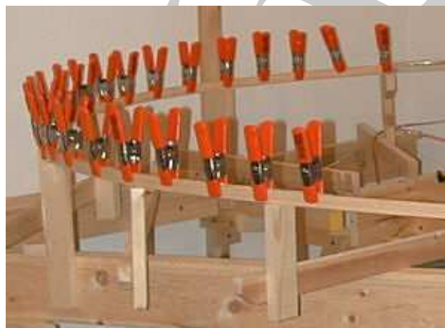
Figura 3.29: Utilizzo dello strumento spline in un cantiere navale
