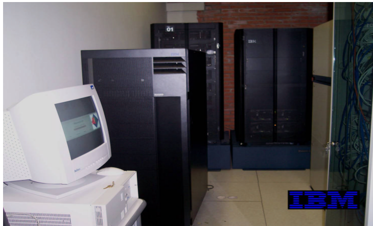
Figura 6.12: Una configurazione IBM SP. In basso a sinistra è rappresentata la control workstation, punto di gestione della macchina, in basso a destra sono invece rappresentate le unità di storage e di backup e in alto sono rappresentati i frames che contengono i nodi.
